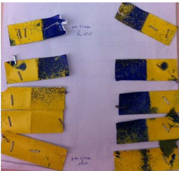
Foto 3: Links zonder lucht ondersteuning rechts met luchtondersteuning
